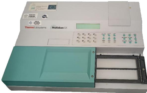
Figura 26. Imagen de un lector de placas Thermo LabSystem Multiskan EX.
