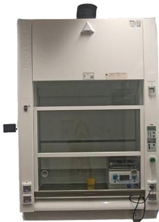
Figura 13. Imagen de cabina de gases de Flores Valles VA120960ADVC+M.
