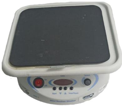
**Figura 3.** Imagen de un agitador orbital Biosan Mini Rocker-Shaker MR1.
