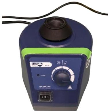
Figura 5. Imagen de un agitador tipo vórtex Lan Technics MX-S.
