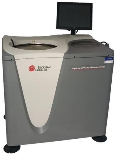
Figura 37. Imagen de una ultracentrífuga Beckman Coulter Optima XPN100.
