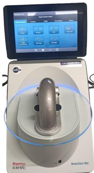
Figura 24. Imagen de un espectrofotómetro ThermoScientific NanoDrop One.
