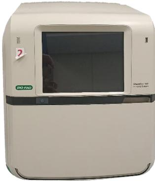
Figura 32. Imagen de un sistema de imagen BIO-RAD ChemiDoc MP.
