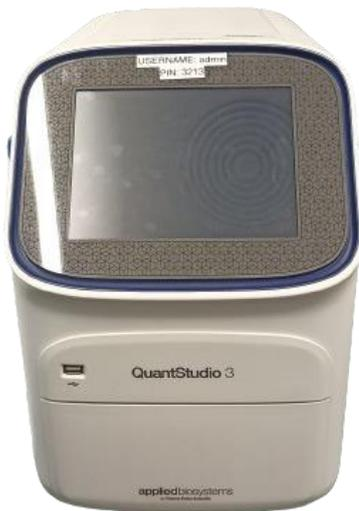
**Figura 36.** Imagen de un termociclador Applied Biosystems QuantStudio 3.
