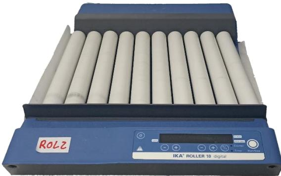
Figura 1. Imagen de un agitador IKA Roller 10 digital
