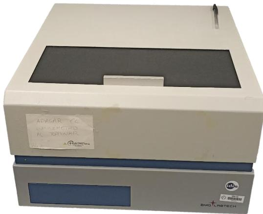
Figura 27. Imagen de un BGM Labtech Fluostar Optima.
