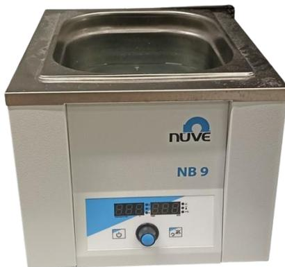
Figura 11. Imagen de un baño termostático Nuve NB9.
